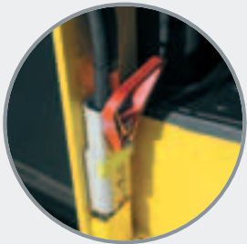
Dźwignia odłączania akumulatora
