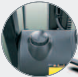
Łatwe sprawdzanie poziomu płynu hamulcowego
